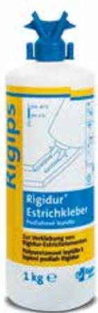
Die Rigidur Estrichkleber sind alle mit einer Doppelstrangdüse ausgestattet, die speziell auf den Stufenfalz der Rigidur Estrichelemente und Rigidur Dachbodenelemente abgestimmt wurde. Durch die Doppelstrangdüse ist der Kleberauftrag auf der Plattenkante und der Fläche gewährleistet.
